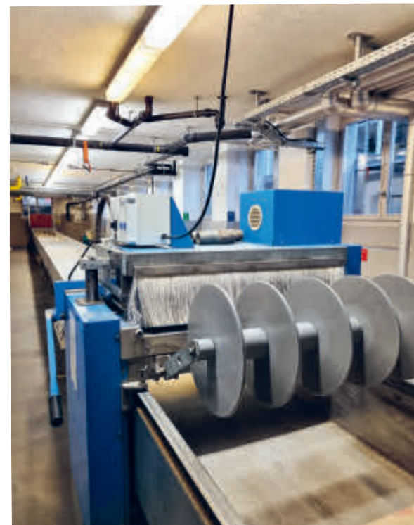
Auch bei der Feuerwehr gibt es eine Waschküche. In dieser speziellen Waschmaschine werden die benutzten Schläuche nach dem Einsatz gewaschen.
